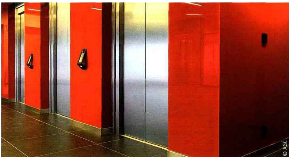
L'aspect brillant et coloré du verre laqué est obtenu par le dépôt d'une couche de laque très résistante sur la face arrière du verre.
